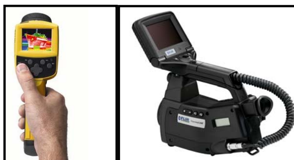
Fig. 10 - Duas câmaras termográficas específicas para utilização em edifícios (B2 e B20)
