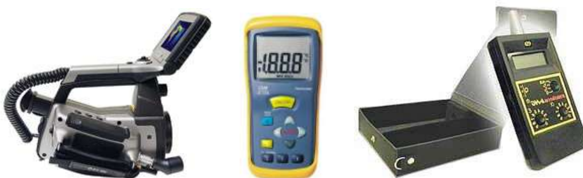
Fig. 2 - Câmara termográfica FLIR, termómetro de contacto e medidor de radiação
