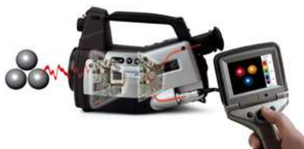
Fig. 7 – Funcionamento esquemático de uma câmara termográfica
