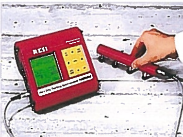
Figura 5. Medidor de resistividade do betão.
