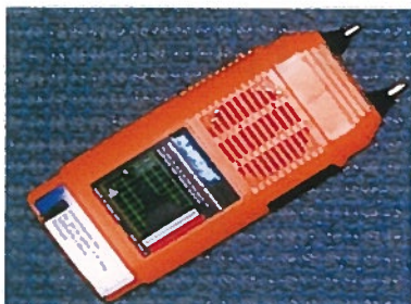
Figura 6. Detector electrosónico de humidade.
