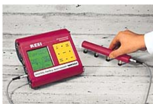
Fig. 5 - Medidor de resistividade do betão
