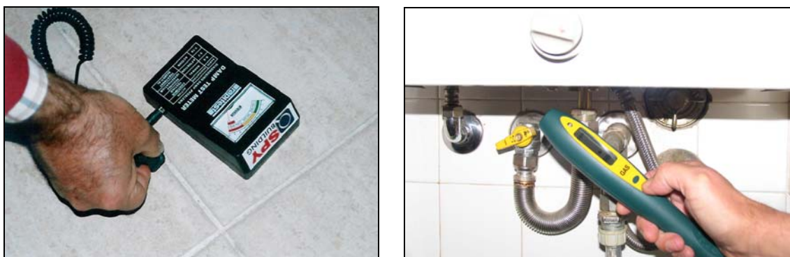
Fig. 4 - Detecção de humidade e de fuga de gás
