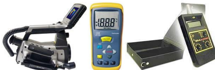
Fig. 5 - Câmara termográfica FLIR, termómetro de contacto e medidor de radiação
