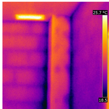
Fig. 23 – Detecção de Corete
